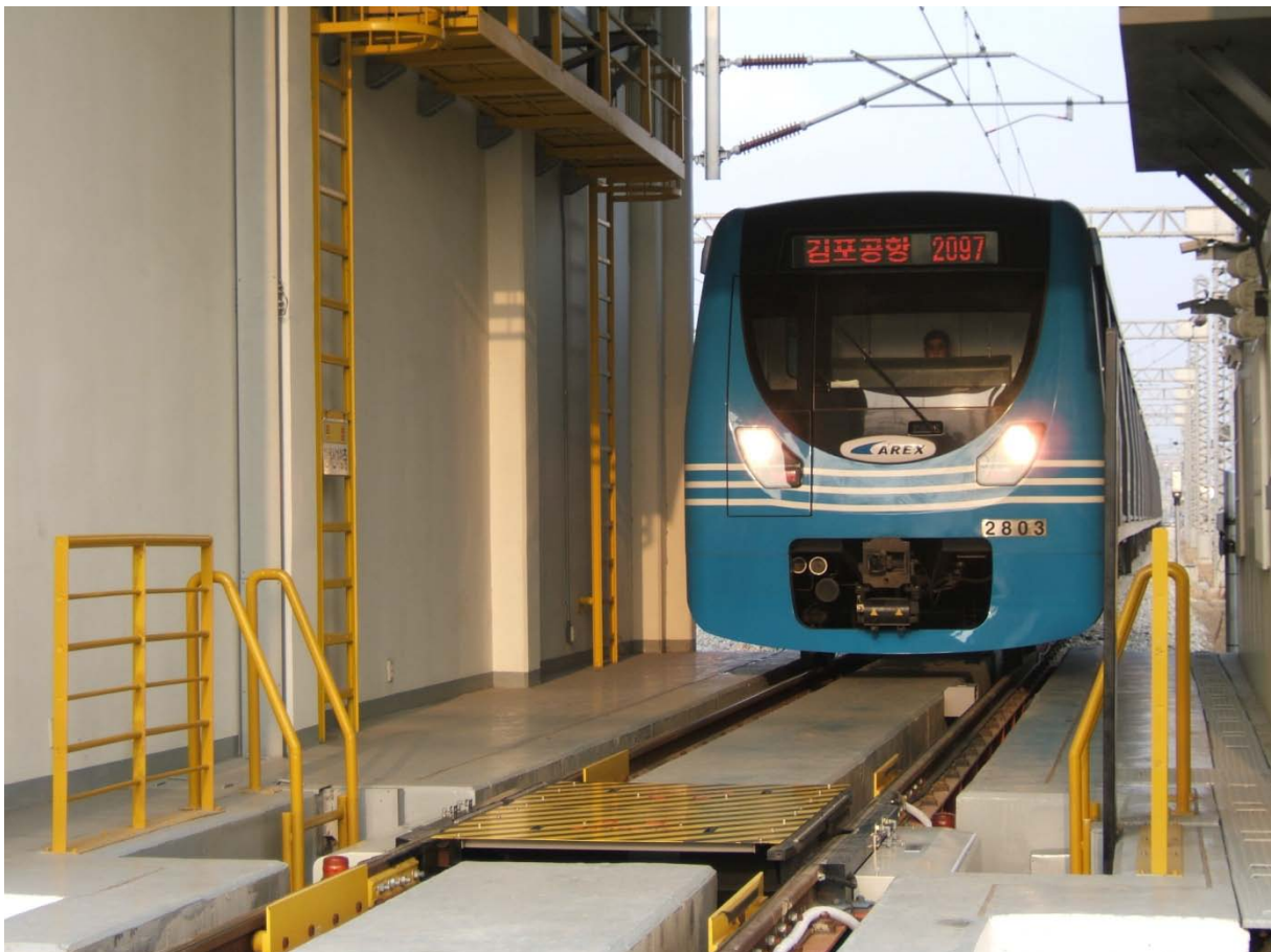
Foto: Talگو Radparametermessanlage EVA im IREX-Depot Seoul
